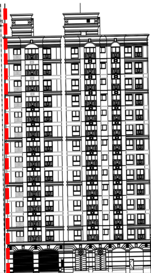
右向立面圖 傾斜角度=1度
