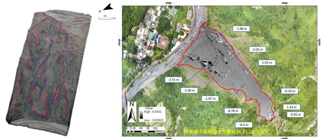
新竹秀巒崩塌區災後CS立體圖地表特徵、地表高程及土方量體分析
